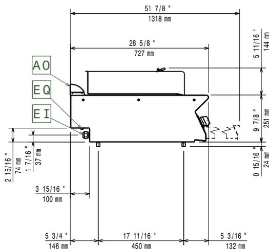
EI = Conexión eléctrica (energía)
